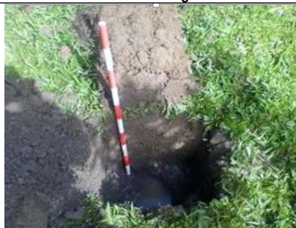
Foto 11. Prueba de garlancha anegada a los 50cm de profundidad
